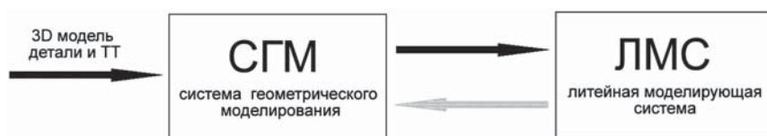
Рис. 2. Типовая схема проектирования литейной технологии
